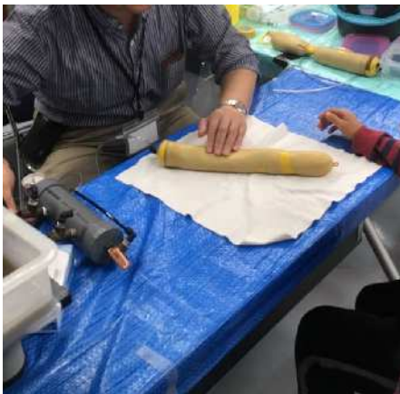
写真.2 真空ポンプを用いた砂の圧力効果実験装置 ゴムの袋に詰められた砂粒の間の空気をポンプで抜き密度を変化させると、砂の硬さが変化することを体験させます。
